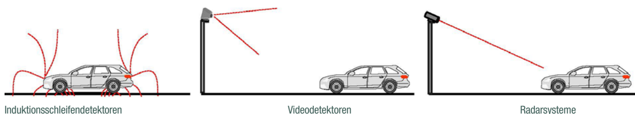
Abb. 1 | Messeinrichtungen für eine Verkehrserfassung (exemplarisch)
